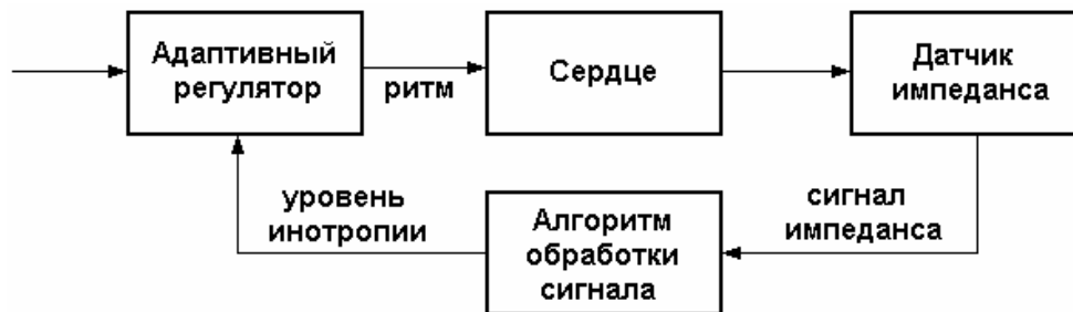
Рис. 4. Структурная схема системы регуляции ритма на основе сигнала внутрисердечного импеданса
