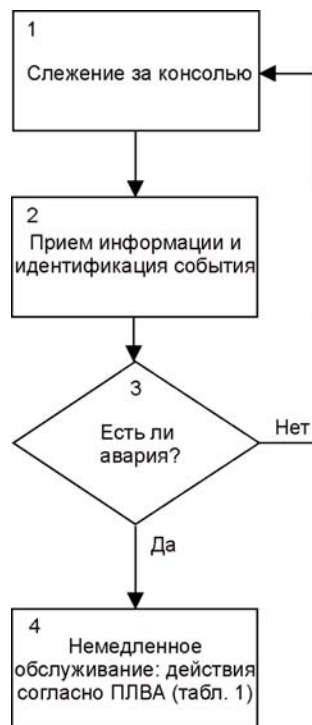
Рис. 1. Структурная схема деятельности оператора-технолога с немедленным обслуживанием ситуаций
