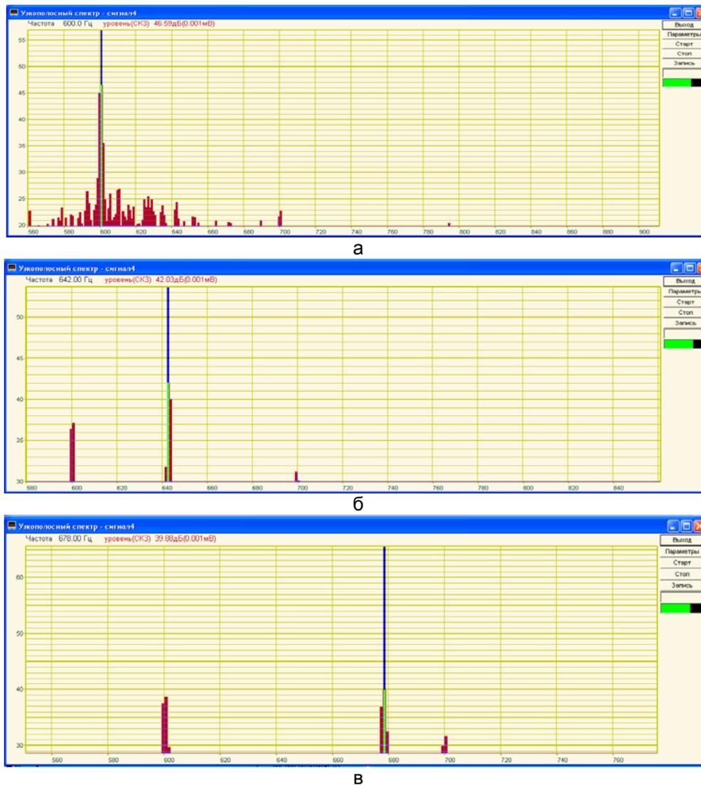
**Рис. 3.** Изменение несущей частоты спектра по мере закрытия задвижки
