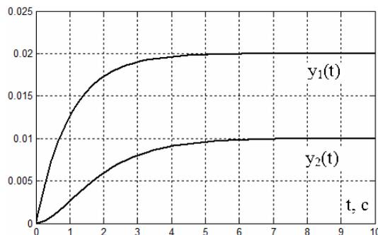
**Рис. 4.** Переходные характеристики на выходе системы управления при расчете матрицы ОСС по выражению (1)
