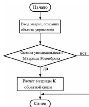
Рис. 1. Блок-схема алгоритма расчета СМУ
