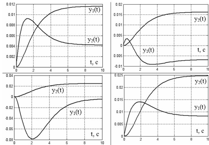
**Рис. 3.** Переходные характеристики на выходе системы управления при расчете матрицы ОСС классическим методом
