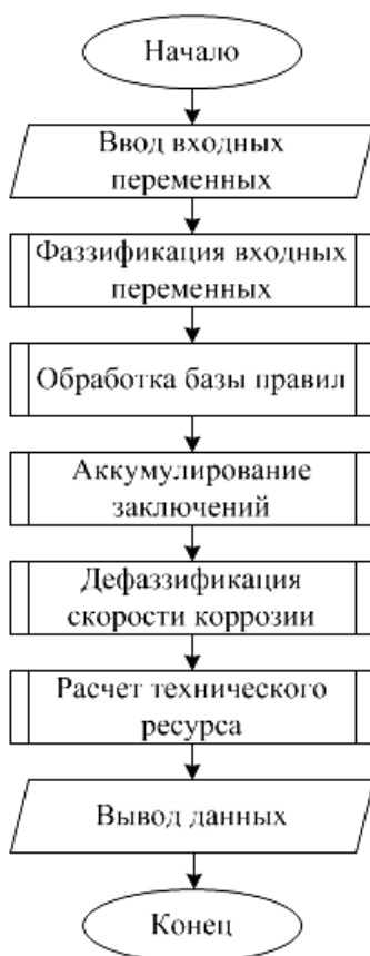
Рис. 3. Алгоритм работы программы расчета потенциально прогнозируемой скорости коррозии и остаточного ресурса МГ
