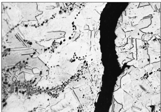
Рис. 25. Фотографии микроструктур (увел. 120). 1–6 — ножи, ан. 950, 933, 935 (1, 3, 5 — срез черешка; 2, 4, 6 — срез лезвия); 7, 8 — тесло, ан. 965 (сечение обуха).
